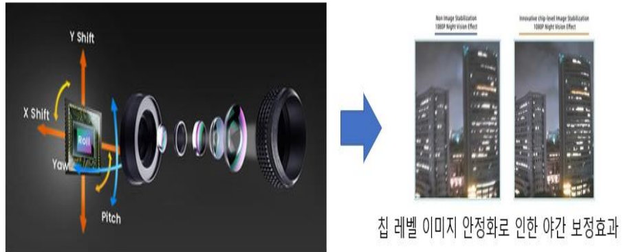
[도표 19] 센서 쉬프트(Sensor-Shift: 내부 렌즈 이동을 통한 흔들림 보정)
