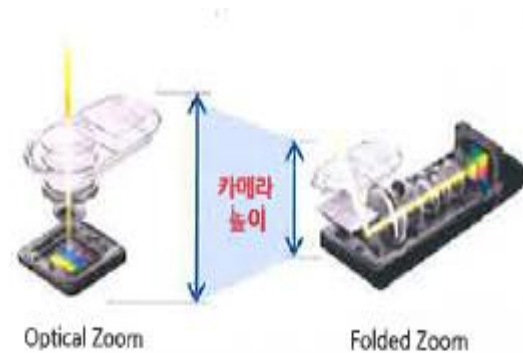
그림5. Optical 줌과 폴디드줌의 차이
