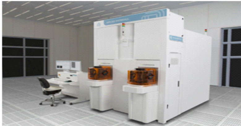
[그림3] Applied Materials Inc의 차세대 전자빔 검사 장비 Applied PROVision™
