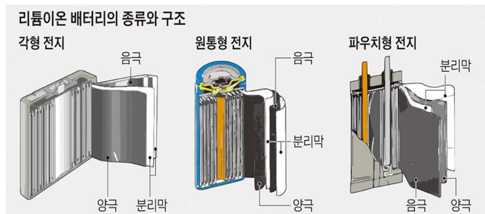
그림 106. 리튬이온 배터리의 내부 구조
