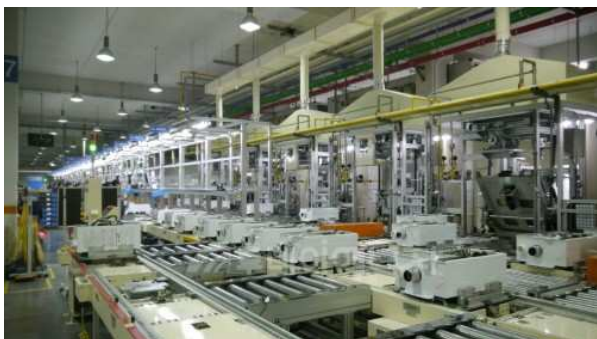
그림6 경동나비엔 서탄 공장_ 자동화 조립라인
