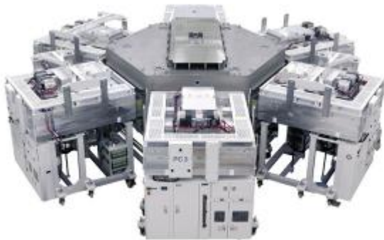
디스플레이 장비 (1) - Oxide PE CVD (LCD 제품의 변형)
