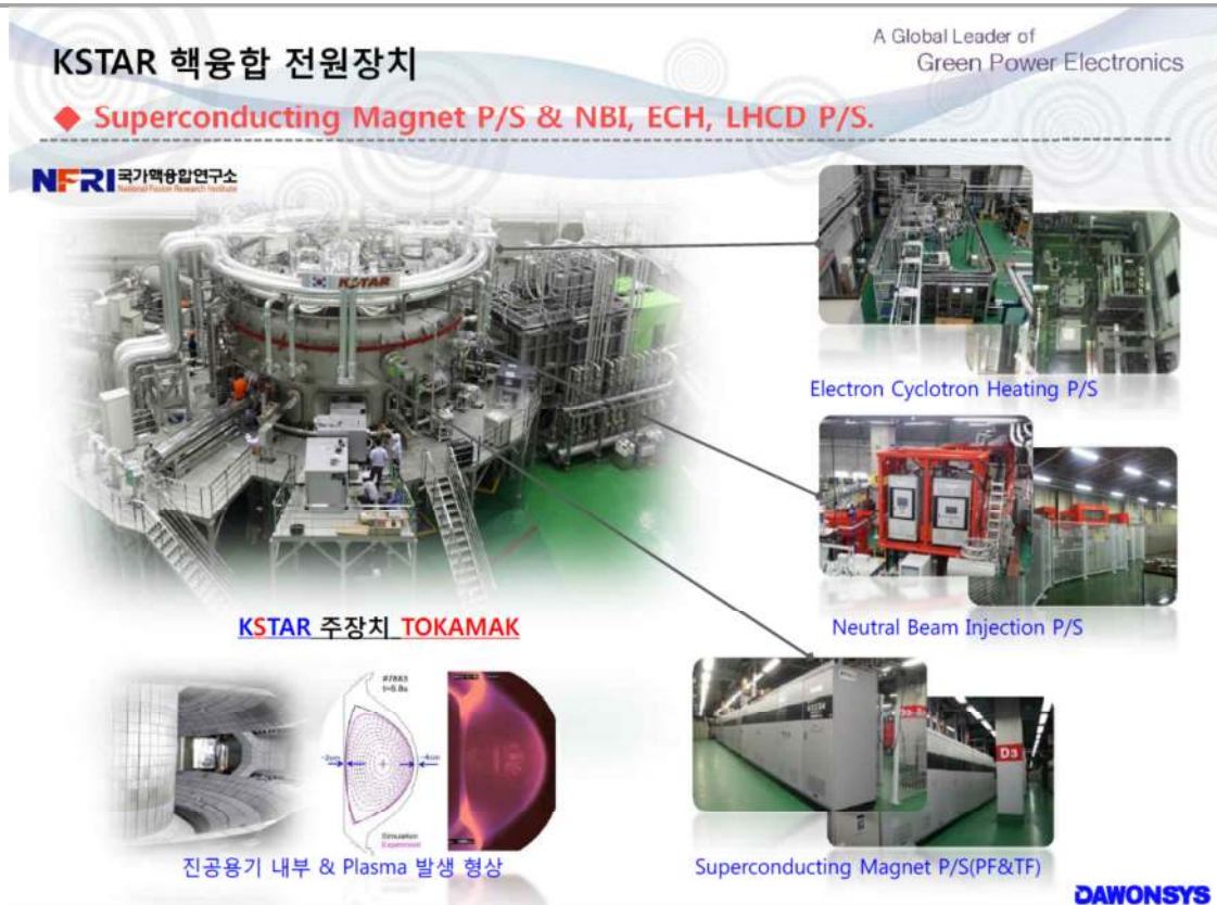
그림6 KSTAR 핵융합실험로 개념도와 전원장치
