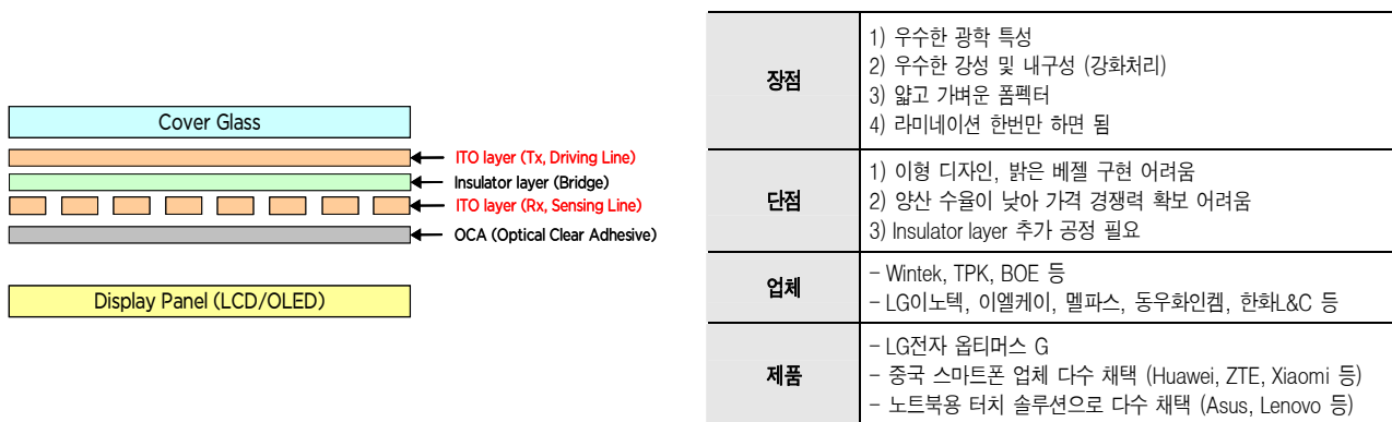
그림 40. G2 (One Glass Solution) 구조
