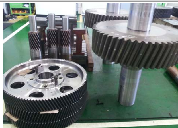
그림 118. 우림기계 북미 수출 제품 - 자원 시추용 감속기 부품
